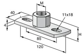
**Technische Daten** für Standard-Grundplatte (metrisch) MGS 2-R
