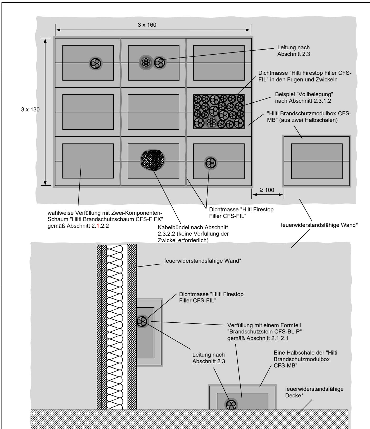
\* gleiche Feuerwiderstandsfähigkeit der angrenzenden Bauteile bei halben Boxen vorausgesetzt
