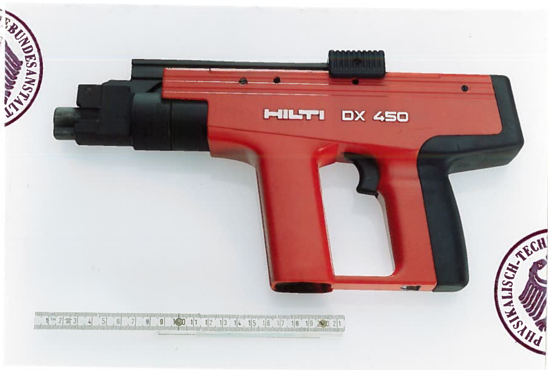
Abb.: Bolzenschubwerkzeug DX 450 für Kartuschenmunition 6,8/11 M
