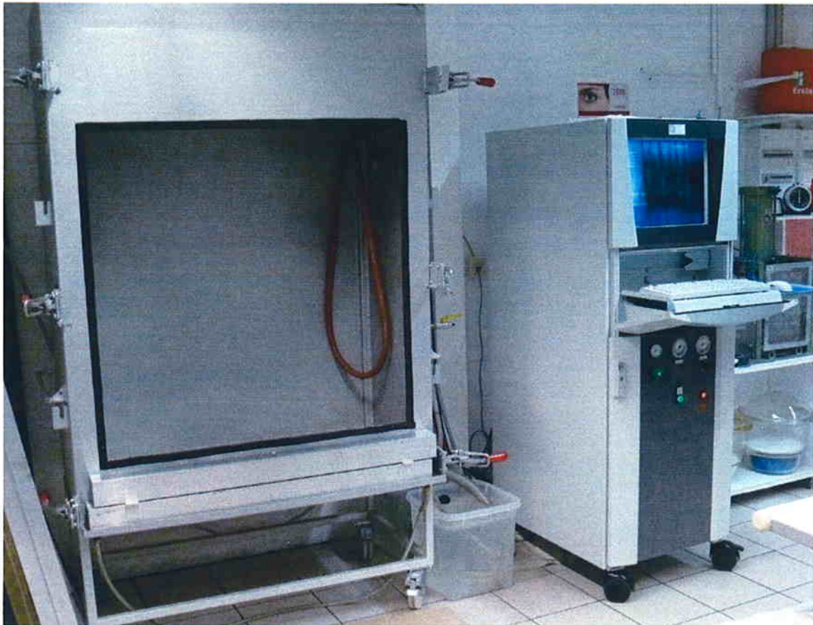
Bild 1: Versuchsstand ohne Probekörper mit Regeleinrichtung
