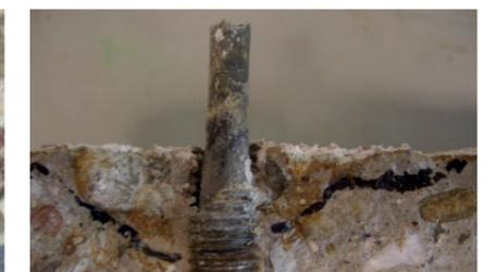
Beständigkeit des Befestigungspunkt setzt Beständigkeit von Untergrund, Befestigungselement und Verbundmörtel voraus
