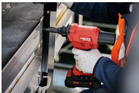
Bild 2: Aufgrund einer neuen Haltenase ist das einhändige Arbeiten möglich.
