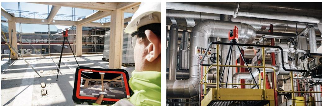
Bild 3: Nutzung des P3D 800 Laserscanners in mit PLC 600 Tablet und Hilti OnSite Scan Software.
