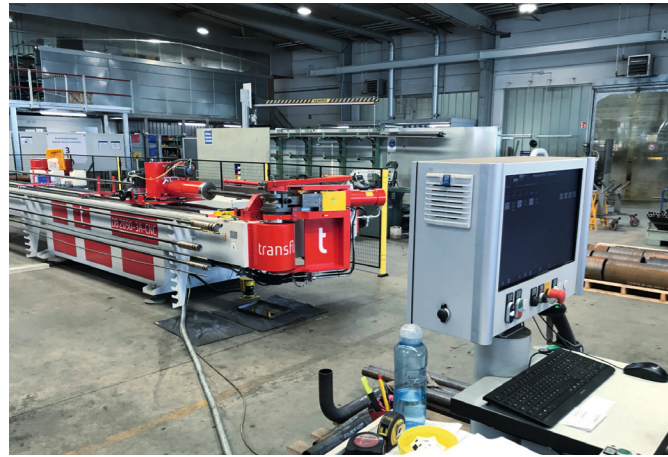
Abbildung 9: CNC-gesteuerte Maschine der Fertigungsstraße
